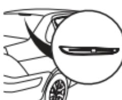
Displej umístěte na přístrojovou desku nebo v horní části předního skla, aby byl pro řidiče dobře viditelný. Displeje M7 a M8 je možné umístit i v horní části zadního skla.
