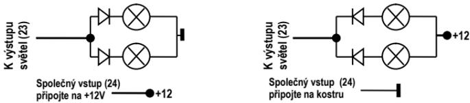
Obr. 3 Příklad zapojení světel (pro přímé ovládání obou světel je nutné zapojit diody)
